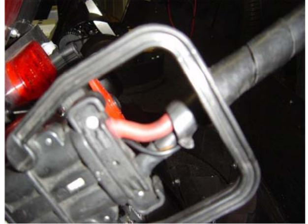
Les prises femelles sont dissymétriques et possèdent une face plate. Pour la fixation sur le côté GAUCHE du kart (vue arrière dans le sens de marche), la borne positive +48V se retrouve en HAUT, ainsi que le contact auxiliaire. La borne négative -0V se retrouve en BAS.
