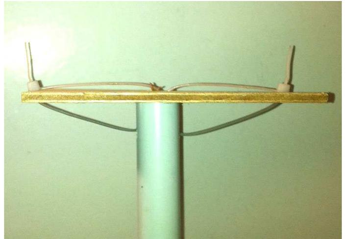
*Figure. Exemple de fixation sur un kart : tube plastique rigide 20mm + 2 colliers de serrage*
